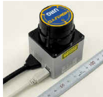
(d) Hokuyo URG Laser Rangefinder: Power 2.5W, Weight 0.16 Kg
